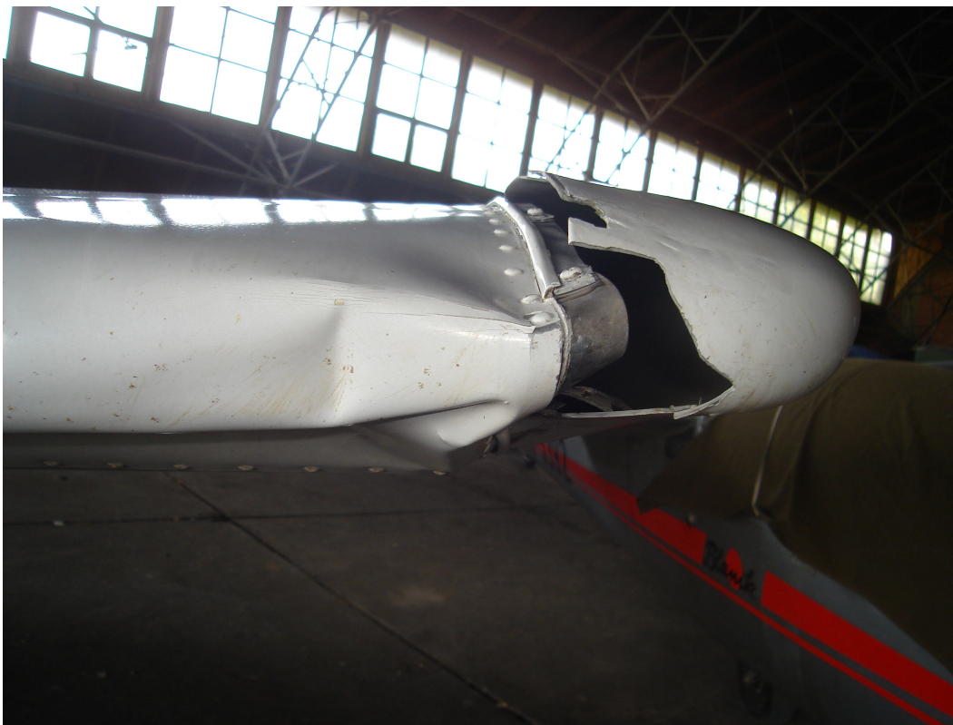
Слика бр. 6. Оштећење терминезона и дела левог крила
