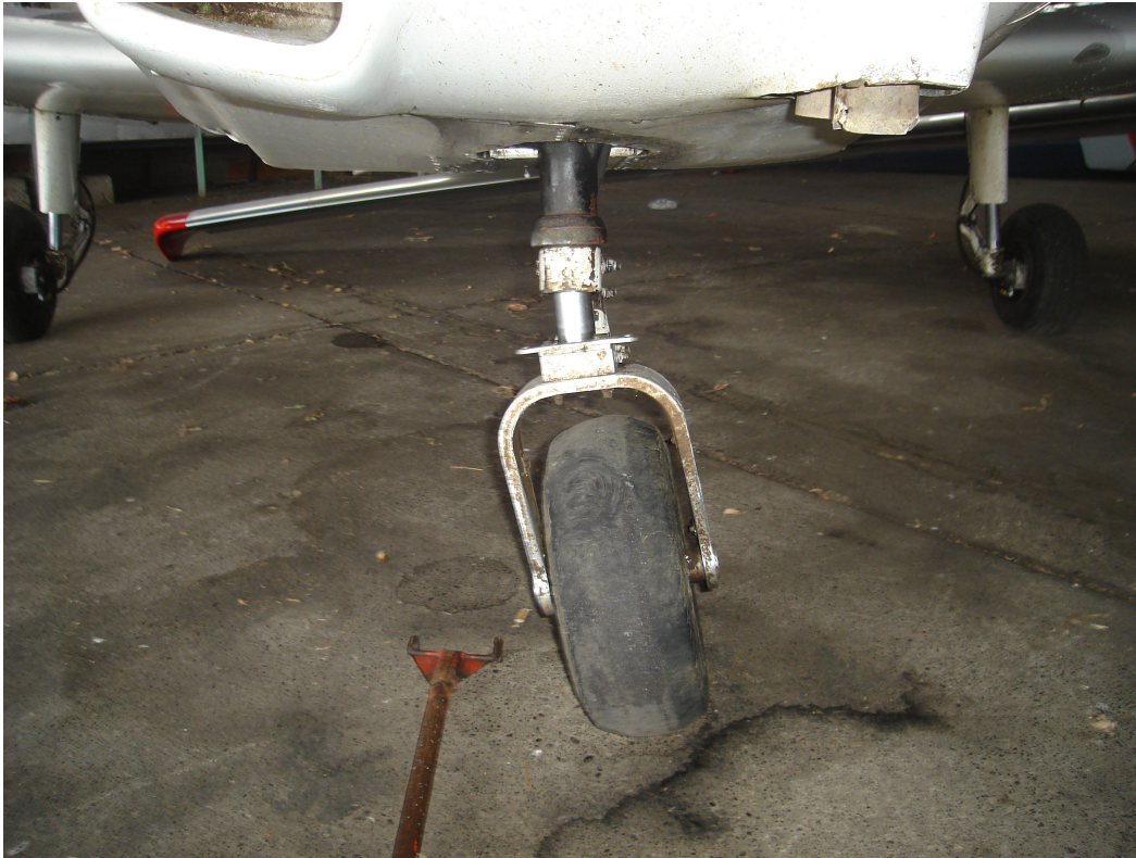
Слика бр.5.Оштећење носне ноге
