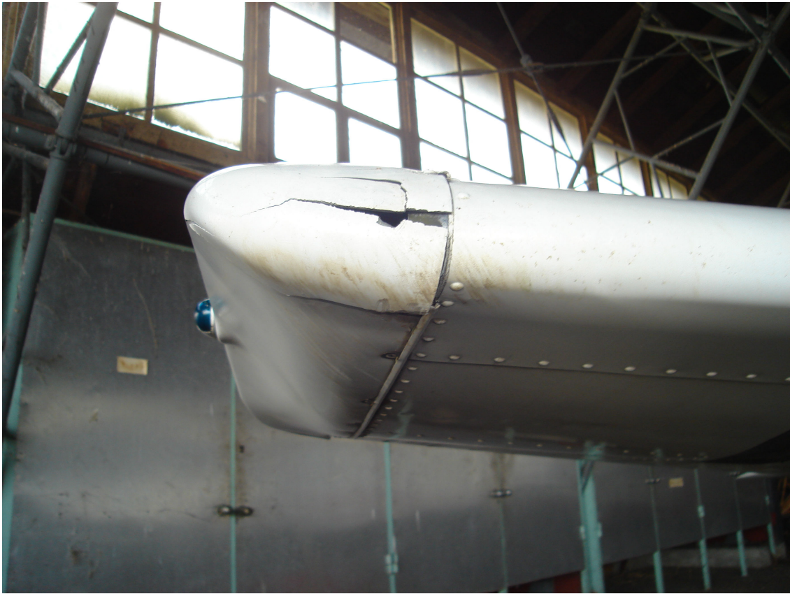
Слика бр. 7. Оштећење терминезона десног крила
